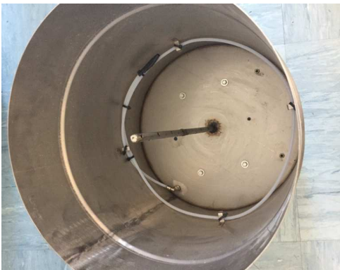
Figura 2 - Interno Flux Chamber con sistema di distribuzione Azoto e asta forata per prelievo
