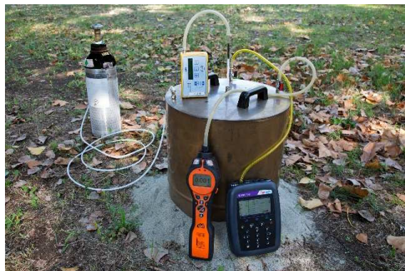
Figura 5 - Flux chamber durante un monitoraggio con strumentazione per controllo VOC, O 2 , CO 2 , CH 4
