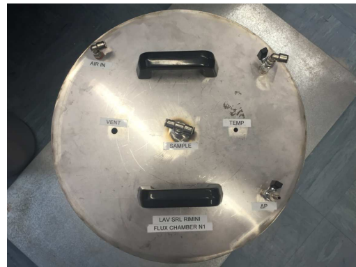
Figura 3 - TOP Flux Chamber con dettaglio foro di VENT, Porte di accesso per sensori e campionamento
